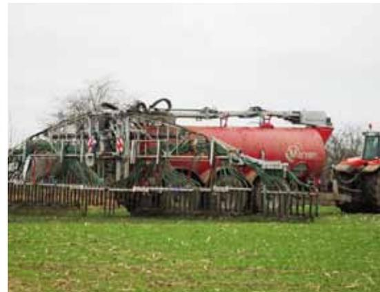
Die Schleppschlauchverteiler von VOGELSANG können mit einer CFC Teilbreitenschaltung ausgerüstet werden.
