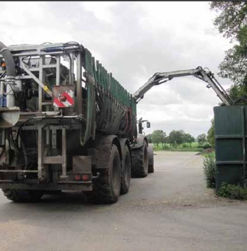
Der aus drei Segmenten bestehende Befüllkran reicht über 4 m hohe Behälter und bis zu 6 m in die Tiefe.
